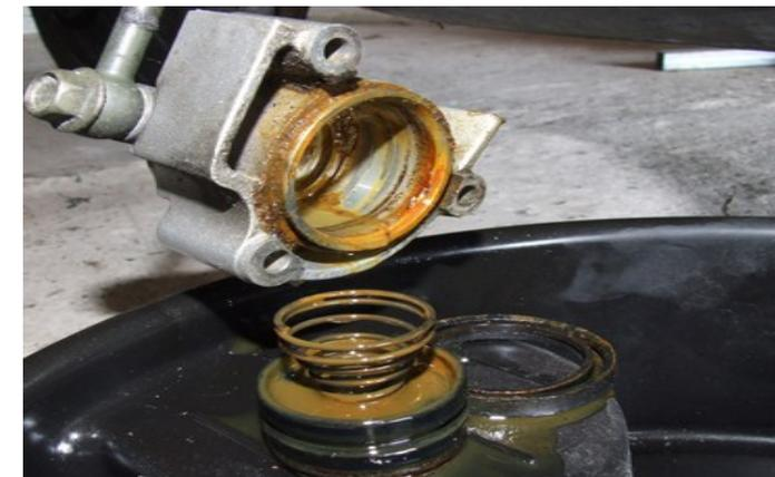
8. Gummidichtung auf dem Kolben war total riefig. Vorne war der Kolben rostig. Die hintere Dichtfläche war fast in Ordnung.
