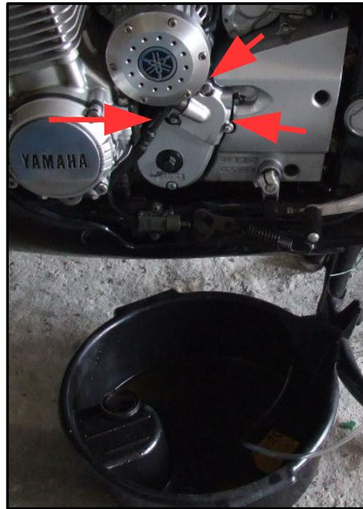
4. Staubschutzkappe geht leicht ab. Da steckte bei mir schon Hydraulikflüssigkeit drin.
