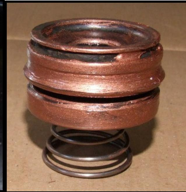
15. Die neue Staubschutzkappe kommt später drauf. Die Lippe des Kolbendichtrings habe ich beim reindrücken des Kolbens leicht in den Zylinder geschoben (mit dem Fingernagel vorsichtig leicht nachgeholfen).
