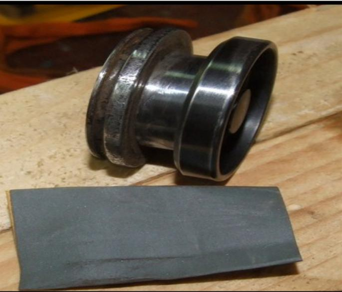
12. Den Zylinder habe ich nur mit dem 2000er gereinigt. Durch die restliche Hydraulikflüssigkeit und weil das 2000er Naßschleifpapier ist, wurde es schön glatt.
