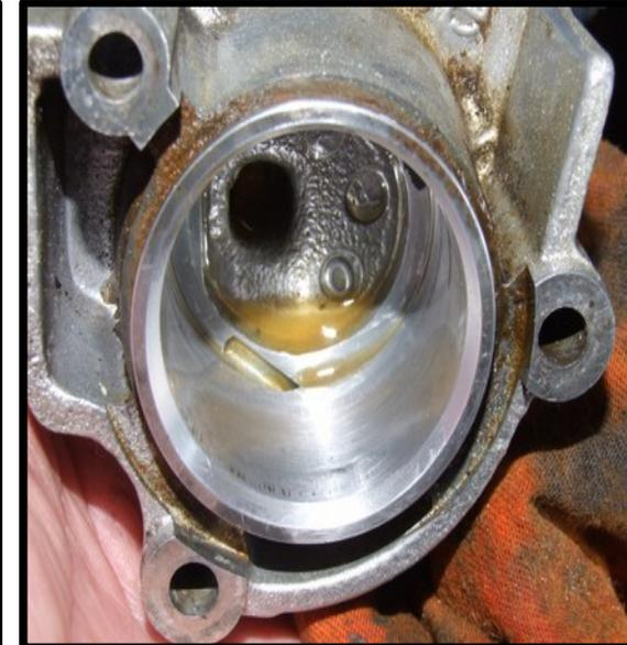
14. Den Kolben und den neuen Dichtring habe ich dann mit Bremspaste eingeschmiert und den Ring mit der Lippe in Richtung Feder übergezogen.
